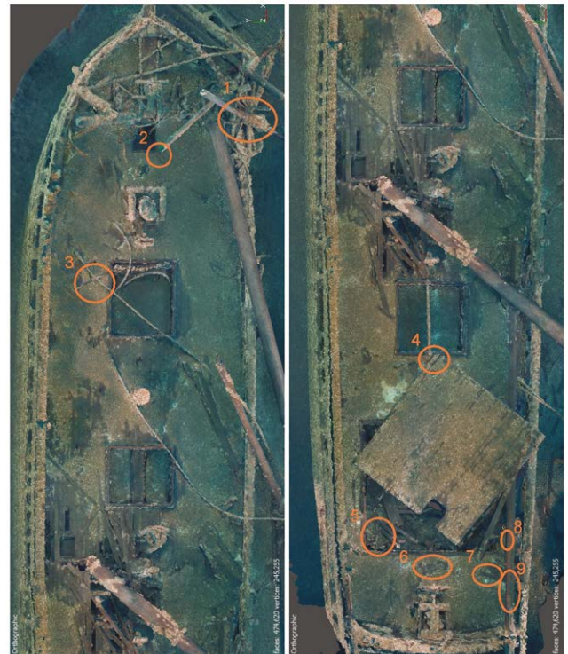
La position des neuf changements potentiels sont indiquées sur ces vues orthographiques de l'avant et de l'arrière du modèle de 2021. Le changement n° 3 s'est avéré un artefact lié à la reconstruction 3D.
